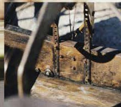
Châssis en bois et direction par cheville ouvrière commandée par câbles et poulies : chaud devant !
